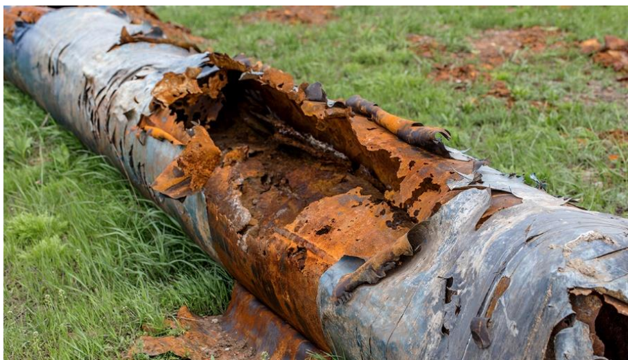
Рисунок 1. Последствия коррозии, вызванной действием сероводорода [5]
