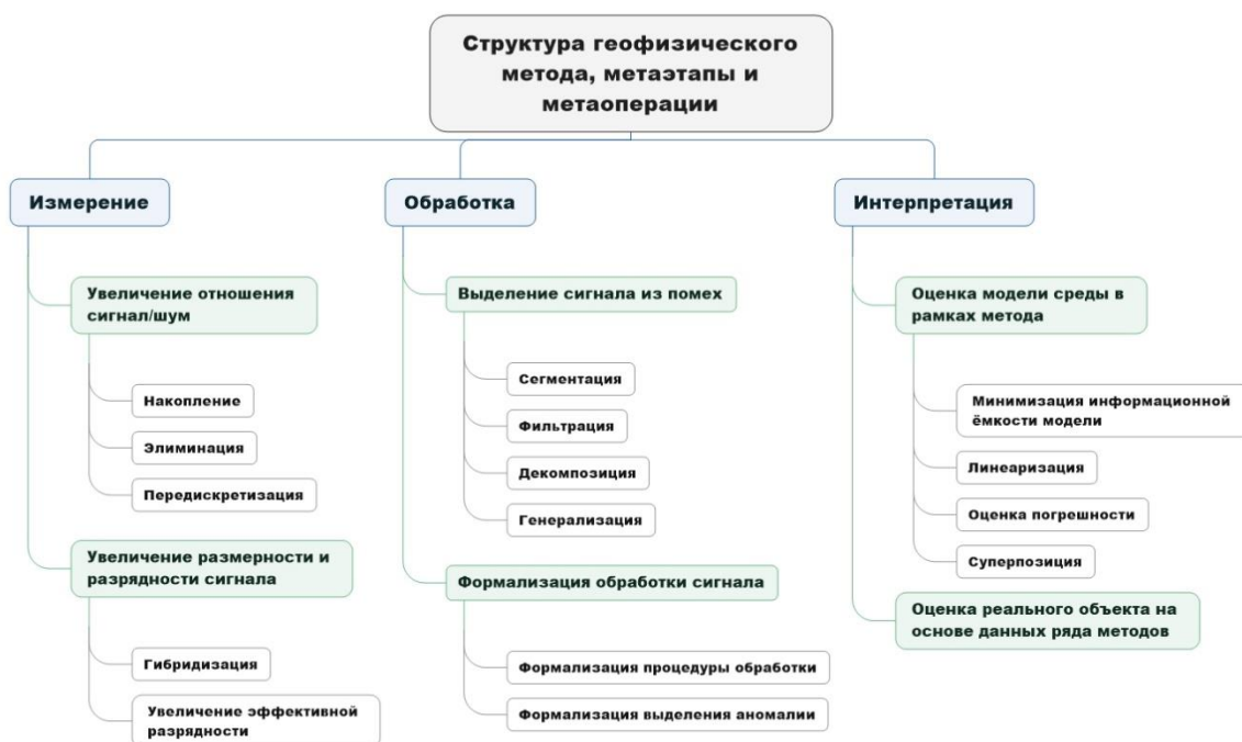
Рисунок 1. Структура геофизического метода, метаэтапы и метаоперации. Элементы структуры метода отмечены голубым фоном, метаэтапы - зеленым, метаоперации без заливки.
