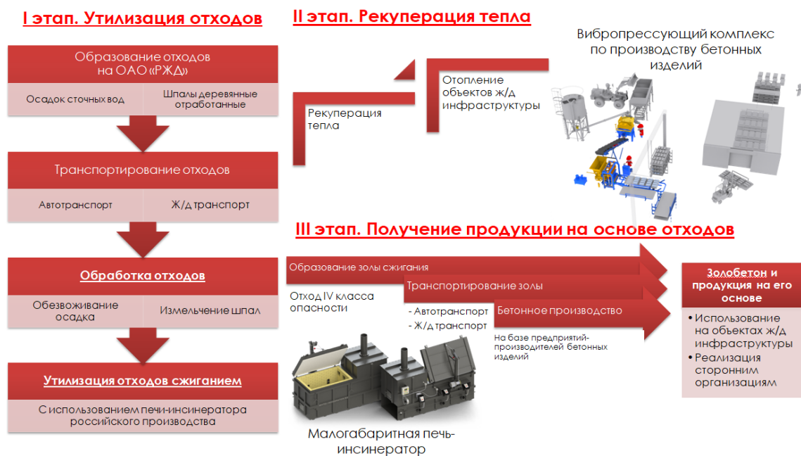
Рисунок 1. Схема переработки отходов объектов ж/д инфраструктуры с получением новой продукции
