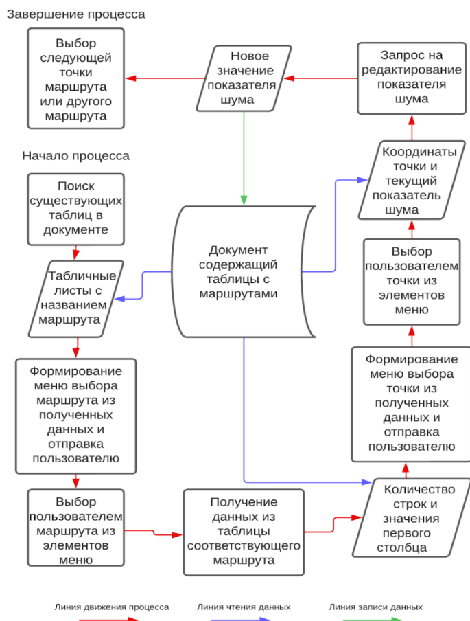
Рисунок 2. Блок-схема процессов функции «Использование готового экологического маршрута»
