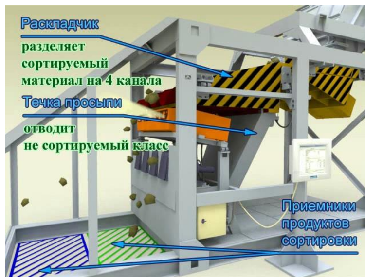
Рисунок 18. Схема работы сепаратора PPC.
