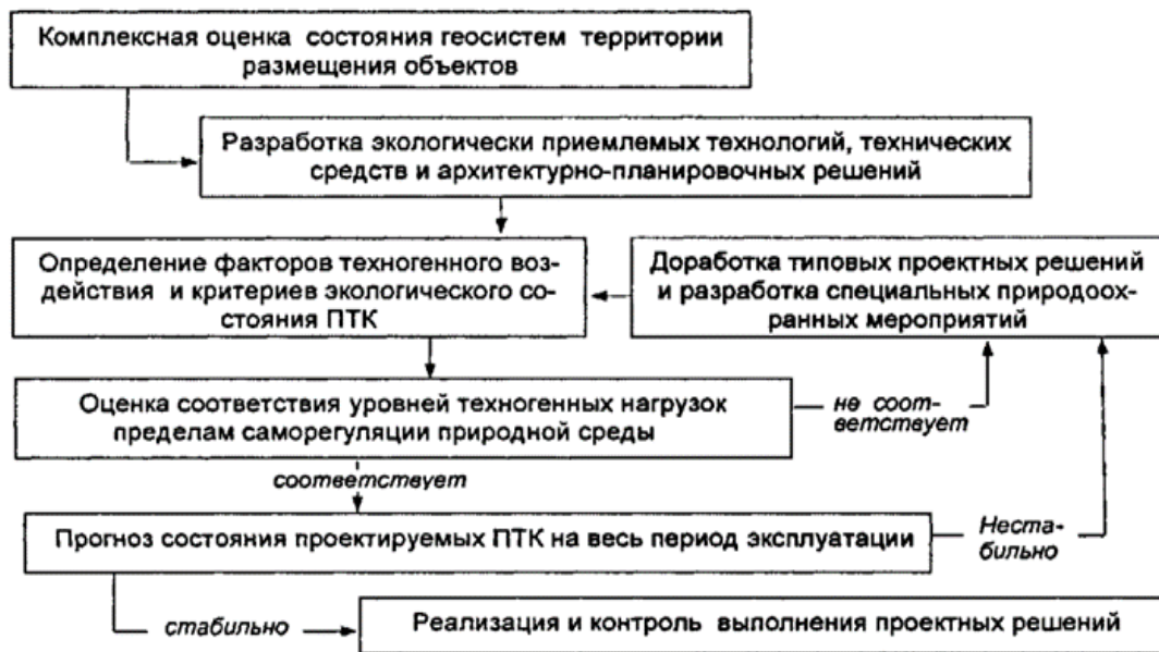
Рисунок 1. Алгоритм обеспечения геоэкологической безопасности проектируемых природно-технических комплексов [4].
